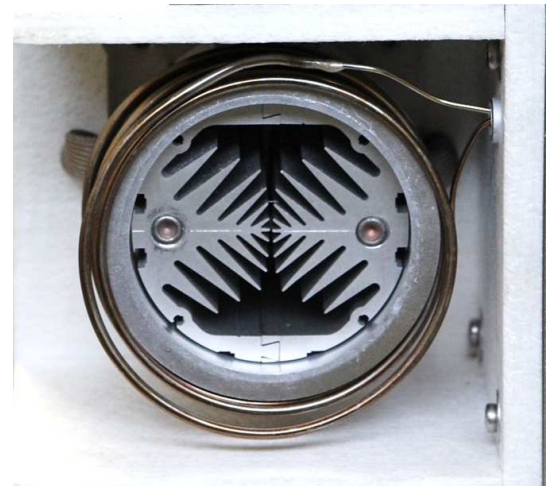
Abb. 2: Säulenhalter mit gepackten Säulen im Externen Säulenofen
