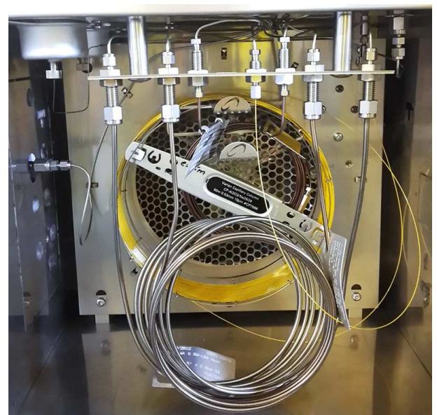
Abb. 9: Teckso Bulkhead-Halterung eingebaut im GC-Ofen (Seitlicher und oberer Einbau)
